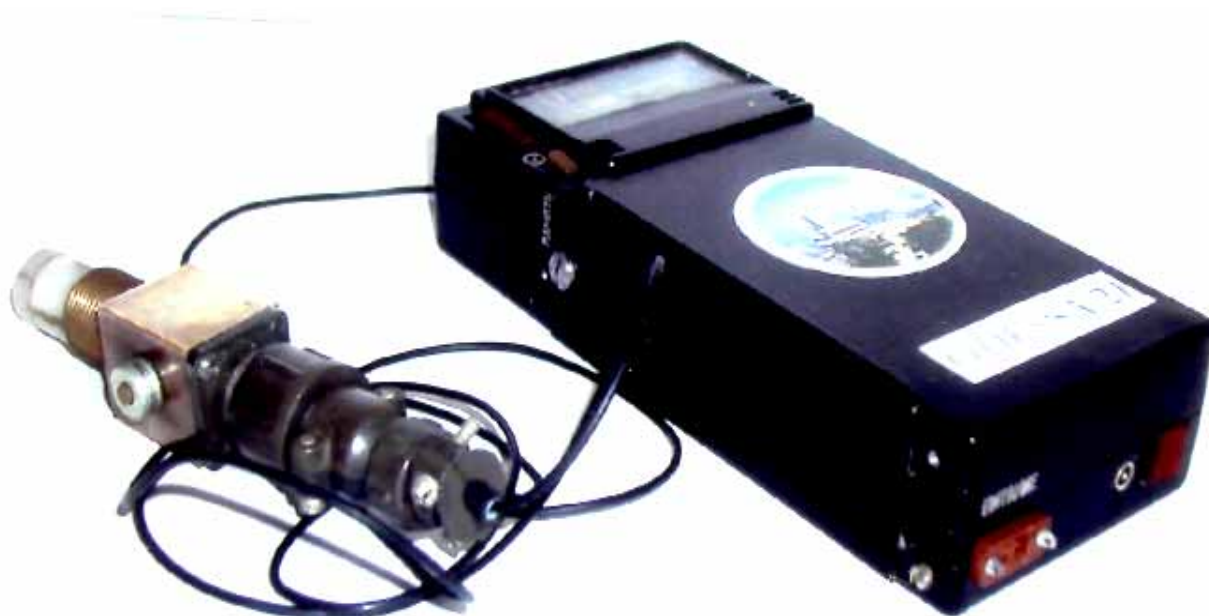
Рис. 2. Датчик износа и регистрирующий блок
