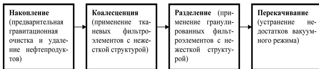
Рис. 3. Вакуумная схема системы очистки НСВ
