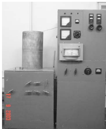
Рис. 2. Лабораторная установка для ионного азотирования материалов деталей СТС
