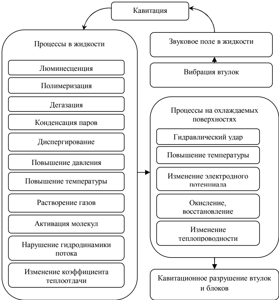
Рис. 1. Схема процесса кавитационного разрушения охлаждаемых полостей СДВС.
