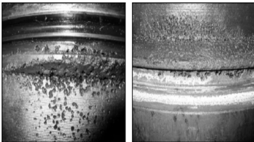
Рис. 5. Кавитационное разрушение цилиндрических втулок судового двигателя.
