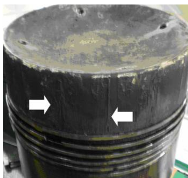
Рис.4. Стан головки поршня: до установки на двигун (а) і після розкриття (б)
