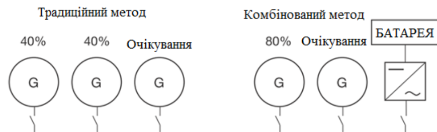
Рис.7. Принцип дії системи з АБ "гарячий" резерв
