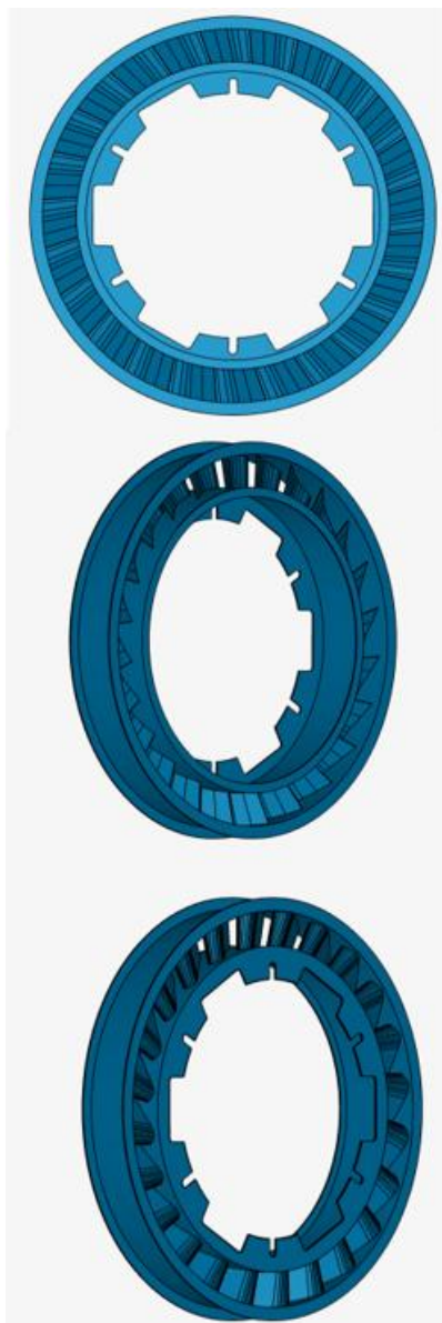
Рис.2. Три-вимірна модель соплового кільця
